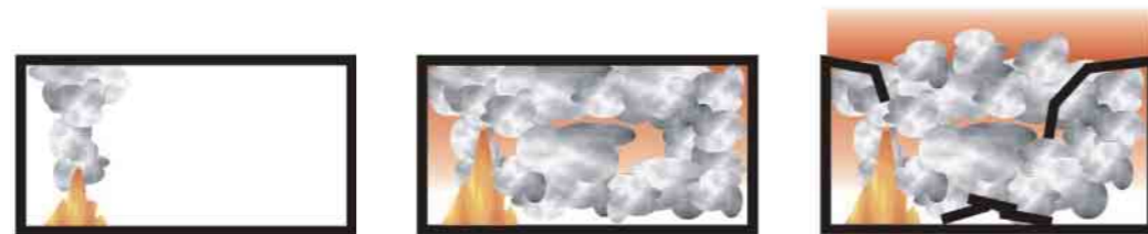
Gebäude ohne RWA A building without SHEVS
